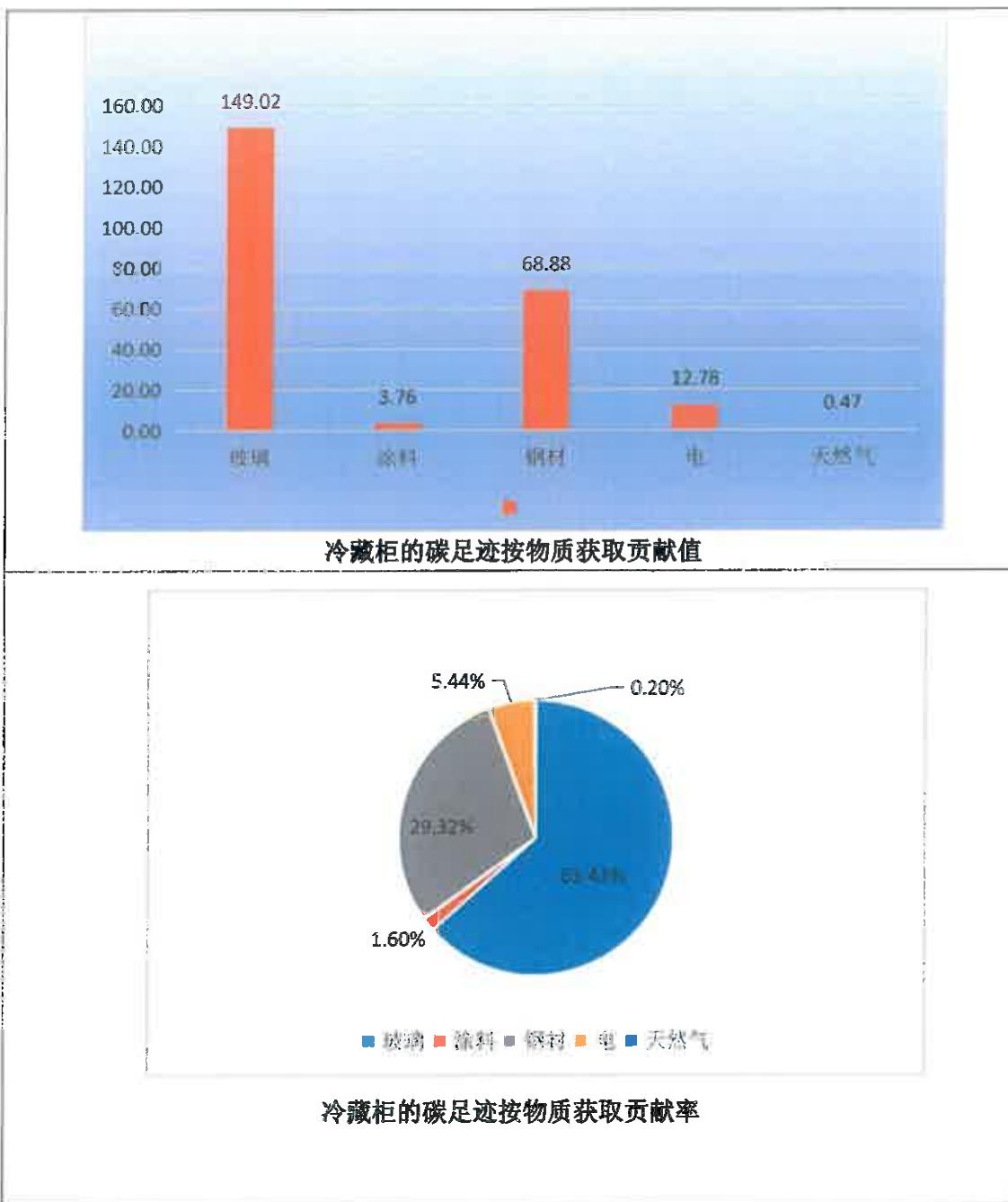
由图可知，冷藏柜生产生命周期过程中，玻璃的获取对其 GWP 贡献最大达 63.43%，其次为钢材的获取占 29.32%，电力的获取占 5.44%，涂料的获取的占
